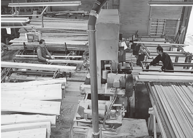
工場内部。素材のトドマツの特徴を瞬時に見極め、用途に合った部材としてカットする作業。熟練の技が必要
